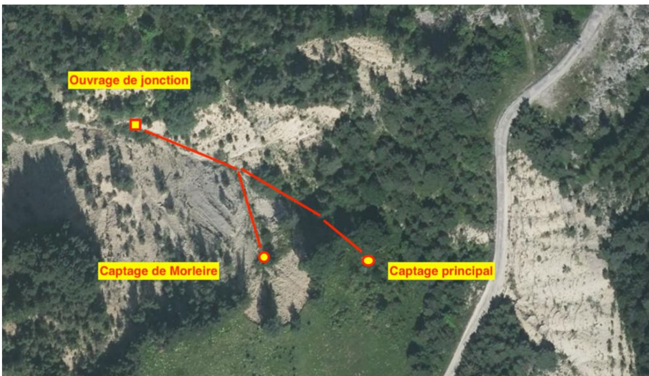
Schéma de principe du captage de la combe de Bonne-Done
